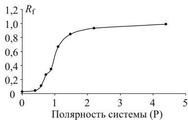
Рис. 3. Зависимость величины R_f от полярности элюирующей системы в диапазоне от 0 до 4,4.
