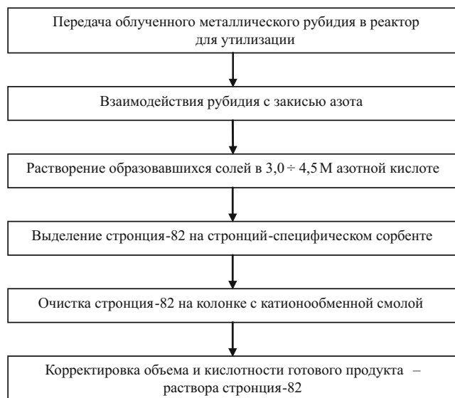
Блок-схема процесса выделения стронция-82.
