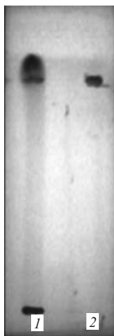
Рис. 3. Хроматограммы аскорбиновой кислоты на пластинке с обращеннофазовым силикагелем RP-18, ПФ этилацетат — уксусная кислота (80:20): 1 — водно-спиртовое извлечение соплодий хмеля, 2 — аскорбиновая кислота.
