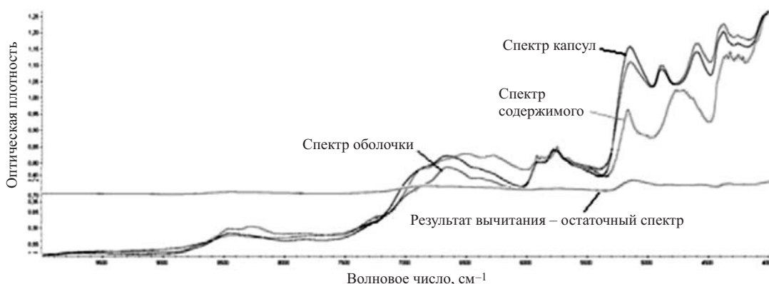
Рис. 7. БИК-спектры интактной капсулы, оболочки и содержимого капсулы и результат их вычитания для ЛП верошпирон.
