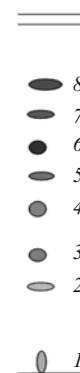
Рис. 4. Вид хроматограммы смеси стандартных образцов АК при хроматографировании в системе n -бутанол — ледяная уксусная кислота — вода (4:1:1), обнаруживающий реагент — 1,0 % раствор нингидрина в спирте: 1 — аргинин; 2 — пролин; 3 — глицин; 4 — глутаминовая кислота; 5 — валин; 6 — метионин; 7 — лейцин; 8 — фенилаланин.
