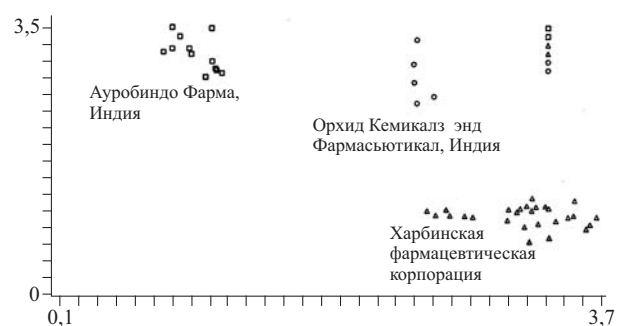
Рис. 2. Визуализированная статистическая модель БИК-спектров нескольких серий субстанции “Цефазолина натрия соль” разных производителей. По оси абсцисс и по оси ординат — статистическое расстояние, единицы Махаланобиса (Mahalanobis).
